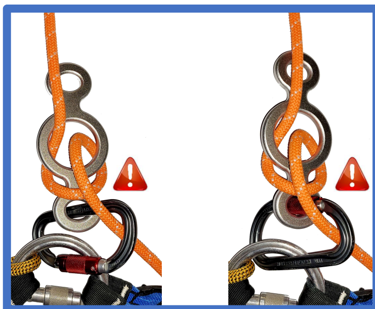
MAUVAISE MISE EN PLACE (DROITIER)
