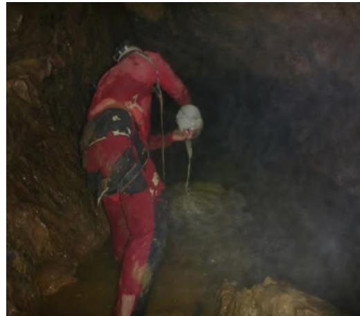
Figure 50: Injection directe d'acide amino G dans la vasque (A. Zappelli et M. Decanis)
