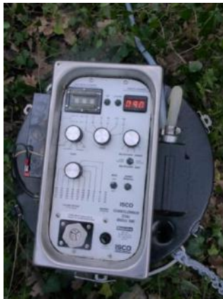
Figure 27: Panneau de commande d'un préleveur automatique. le 02/02/2015
