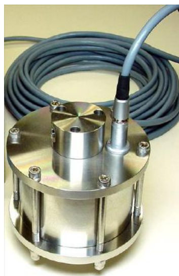
Figure 23: Sonde de mesure de fluorescence (Albilis SARL)
