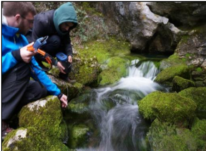
Figure 19: Utilisation de deux conductimètres, le 20/03/2015
