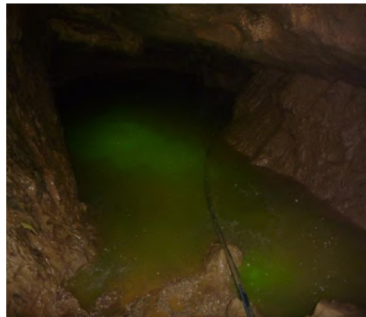
Figure 51: Injection de la fluorescéine (A. Zappelli et M. Decanis)
