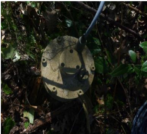
Figure 60: Sonde du fluorimètre encrassée, le 08/03/2015 (A. Zappelli)
