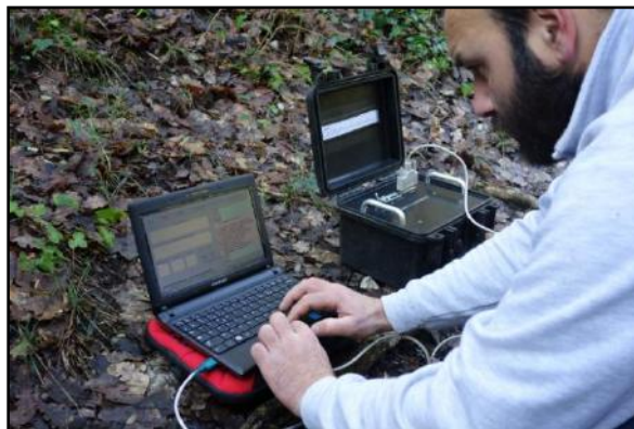
Figure 32: Etalonnage d'un fluorimètre par utilisation d'un PC de terrain, le 20/02/2015
